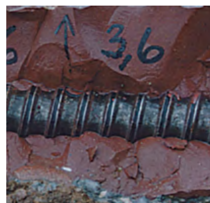
Разрез извлеченной из грунта анкерной сваи ТИТАН 30/11
