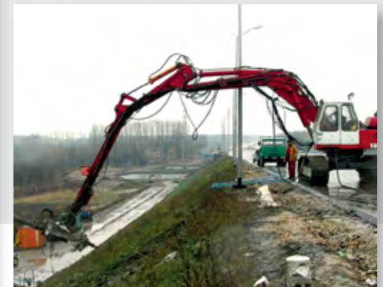
Навесные буровые мачты на обычной строительной технике для бурения малых и средних типоразмеров от ТИТАН 30/16 до ТИТАН 52/26, производителей TEI Rockdrills, Morath и т. д.
