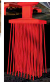
Основание опор эстакады в слабых грунтах на группах из микросвай ТИТАН, скоростная дорога S 7, Польша
