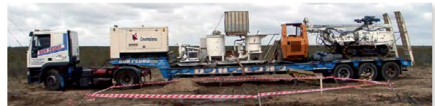
Оборудование для бурения микросвай ТИТАН под ЛЭПы в Аргентине.
