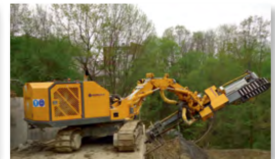
Навесные буровые мачты на обычной строительной технике для бурения малых и средних типоразмеров от ТИТАН 30/16 до ТИТАН 52/26, производителей TEI Rockdrills, Morath и т. д.
